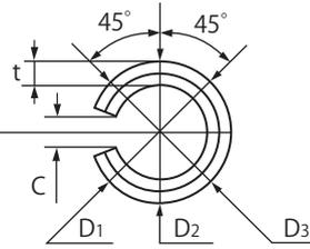
スキマCは、スプリングピンを適用する穴に挿入したとき、辺が接触しないような寸法でなければならない。
